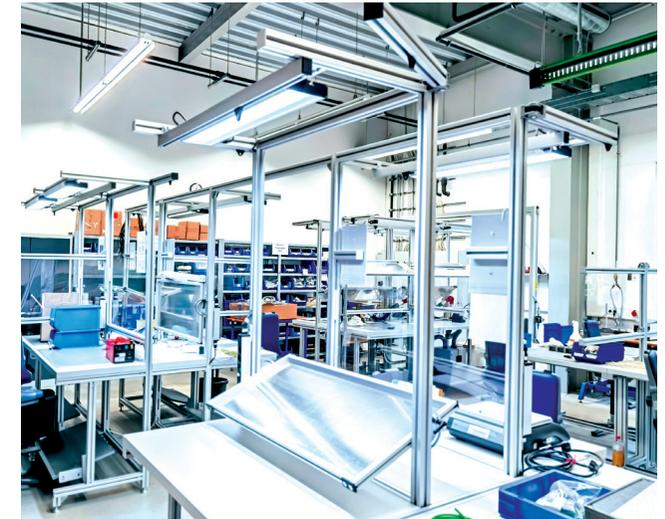
Für den Montagebereich haben wir einen speziellen Montagetisch in Pultbauweise entwickelt:
